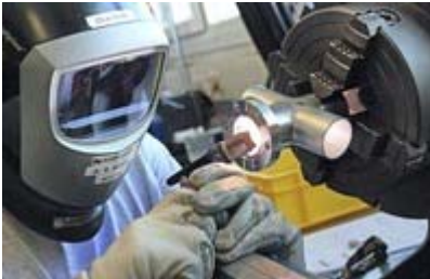
Jungfacharbeiter Danny Zimmermann beim Schutzgasschweißen von Bauteilen. (Foto: OTZ/Prager)
