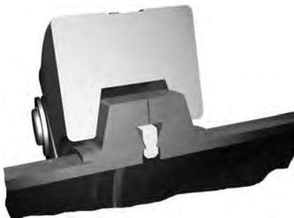
Dichtprinzip QCF-Flansche mit Spannkette
