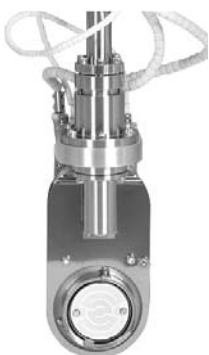
Manipulator mit Aufnehmer für den Probenhalter
