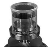
Differenziell gepumpte Quarzglas-Kapsel für Heizelemente
