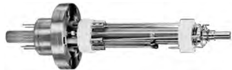
DYCOR Quadrupol-Massenspektrometer mit geschlossener Ionenquelle
